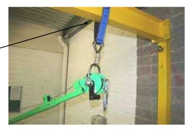
Colocar un Cabrestante como sistema primario, sujeto al Sistema de Montacargas con pértiga. Ver ejemplo.
